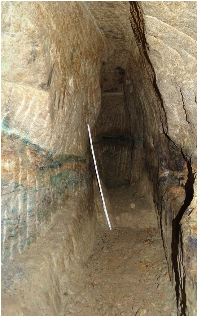
FIG. 1: Fronte di avanzamento con evidenti tracce di lavorazione manuale; alla base il livello mineralizzato con evidenti aloni di minerali di alterazione in corrispondenza del legno carbonificato.
